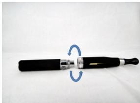
1) Si votre batterie n'est pas chargée (voir "chargement d'une batterie Ego"), chargez-la. Si besoin, remplissez votre clearomiseur en suivant les instructions de ce manuel, et vissez le sur la batterie.
