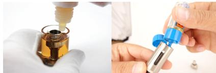
2. Remplir le réservoir entre le tube central et le verre. NE PAS mettre de liquide dans le plot central.
