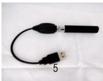
Pour prolonger la durée de vie de votre matériel, nous vous conseillons avant chaque charge de batterie de nettoyer la partie où se visse le clearomiseur à l'aide d'un coton tige ou d'un chiffon sec, car de la condensation peut s'y former, et encrasser voire détériorer le chargeur USB.
