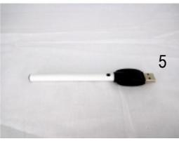
Pour prolonger la durée de vie de votre matériel, nous vous conseillons avant chaque charge de batterie de nettoyer la partie où se visse le clearomiseur à l'aide d'un coton tige ou d'un chiffon sec, de la condensation peut s'y former et encrasser voire détériorer le chargeur USB. Visser la batterie sur le chargeur USB. La fiche USB (5) peut alors être branchée indépendamment sur un port USB d'ordinateur...
